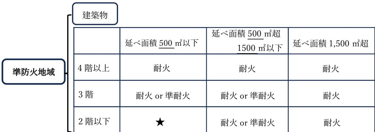
★木造でも OK だが、外壁・軒裏で延焼のおそれがある部分は防火構造
